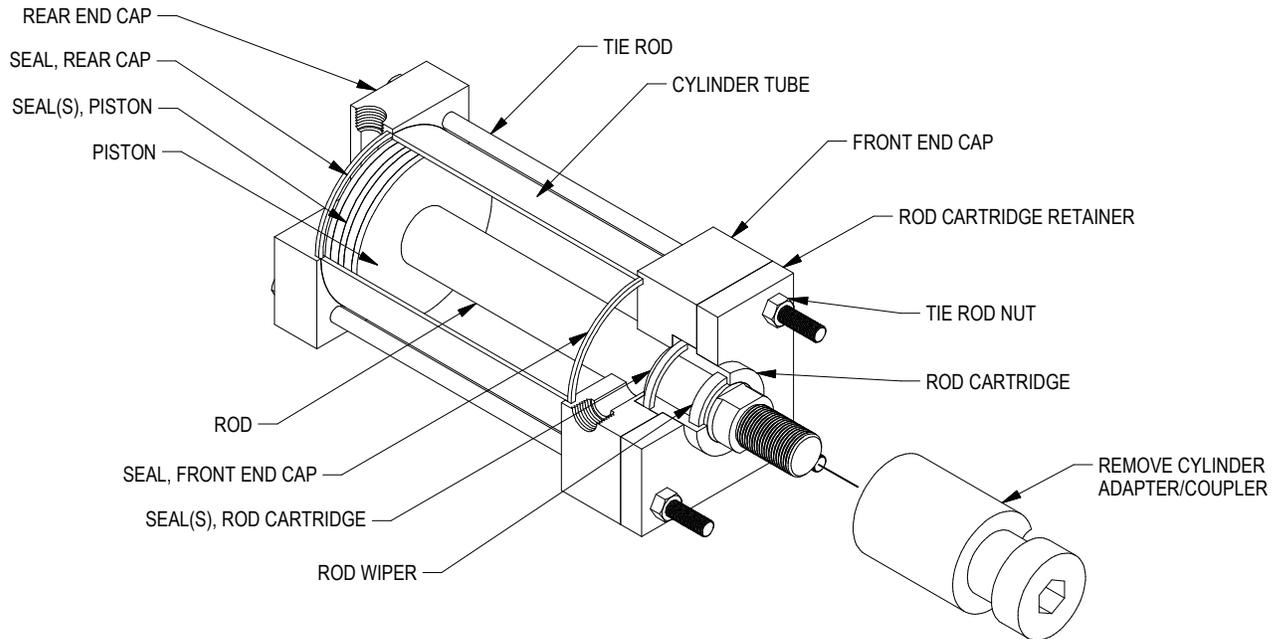
TORQUE TIE ROD NUTS IN ORDER SHOWN. TORQUE TO 22 FT/LB
